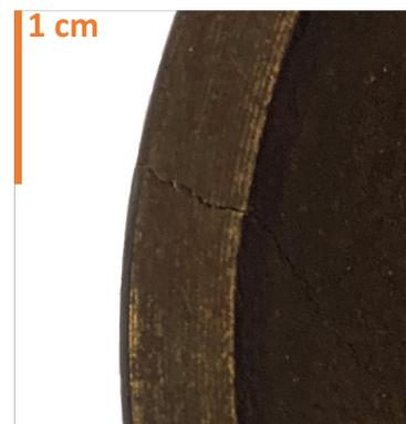
FIGURE 29 – Poulie en fonte - Fissures
